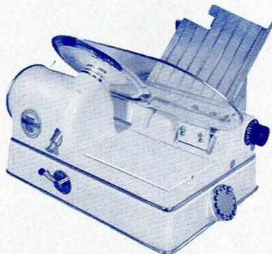
Ce modèle est entièrement automatique. Le mouvement de va-et-vient du chariot se fait automatiquement pour le nombre de tranches fixé (on compose le chiffre sur un cadran et la machine se met en route et s'arrête seule), les tranches tombent sans aucune intervention manuelle.
