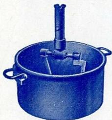
Cuve et batteur pour la fabrication de la crème pâtissière utilisée surtout pour la fabrication des quenelles. Le chauffage est obtenu par une rampe à gaz.
